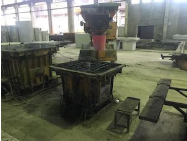
Fig. 1. Realizzazione di un plinto prefabbricato, presso l'Azienda Componenti Vibrocemento Sardegna
