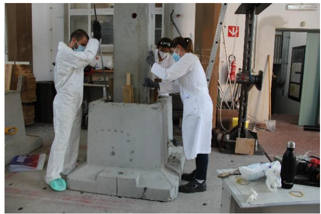
Fig. 2. Getto di calcestruzzo per collegare il pilastro al plinto, presso il Laboratorio Prove Materiali del DICAAR
