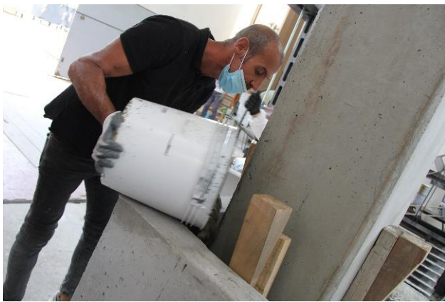
Fig. 2. Getto di calcestruzzo per collegare il pilastro al plinto, presso il Laboratorio Prove Materiali del DICAAR
