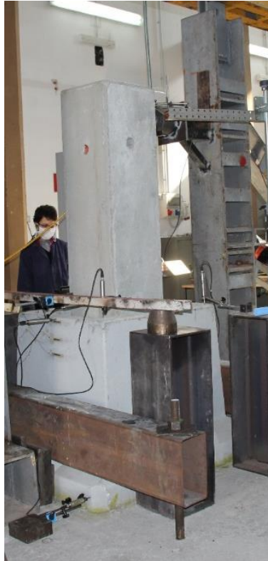
Fig. 7. Particolare della condizione vincolare del plinto
