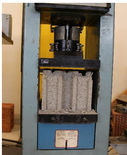
Figura 13. Esecuzione prova di compressione
