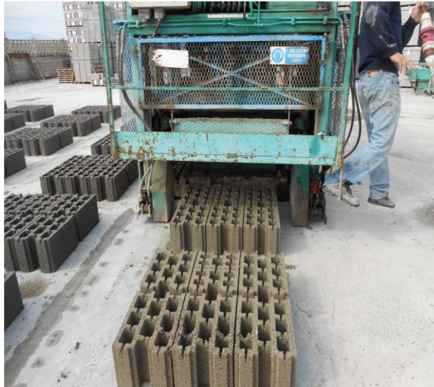
Figura 5. Produzione di blocchi forati di calcestruzzo
